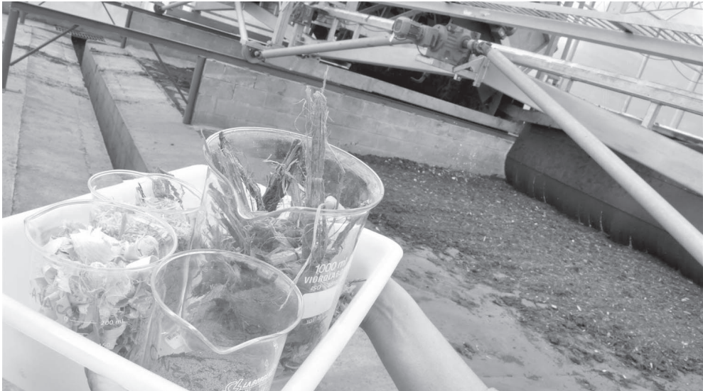
Sistema automatizado irá misturar lodo com restos de poda de árvore
